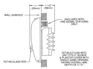
FLUSHINSTALLATION USING P-024900 STEEL BOX
